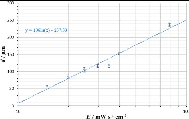
Drucktiefe/Printing-Depth zur Ermittlung der Belichtungszeit für die entsprechende Schichtdicke bei gegebener Leistung.
